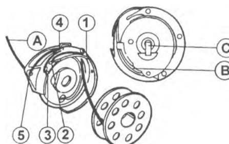
2. Заправить нить в шпульный колпачок, в указанной на рис. последовательности (1) - (5).
