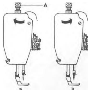
Давление прижимной лапки регулируется в соответствии с толщиной материала.
